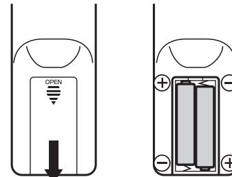
リモコン背面の電池ボックスのカバーを外し、単4型アルカリ乾電池を2本正しい方向で入れて、カバーを戻してください。
